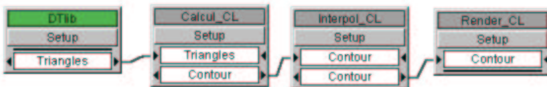
Obr. A.1: Schéma zapojení modulů v systému MVE s modulem DTlib
