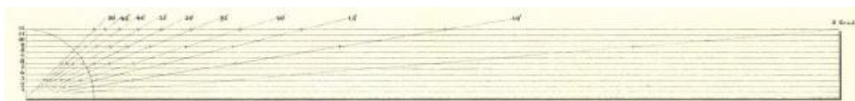
Obr.4.17 Svahové měřítko k odčítání úhlů sklonu na plánech s vrstevnicemi
