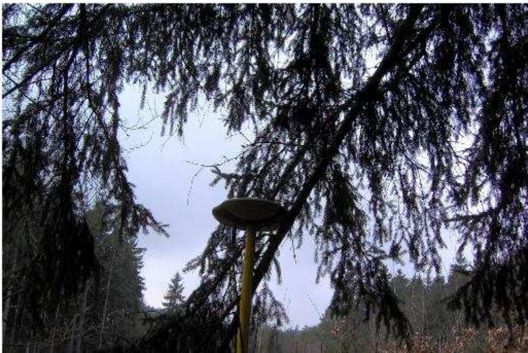
Obr.47 Nepříznivé podmínky při měření GPS
