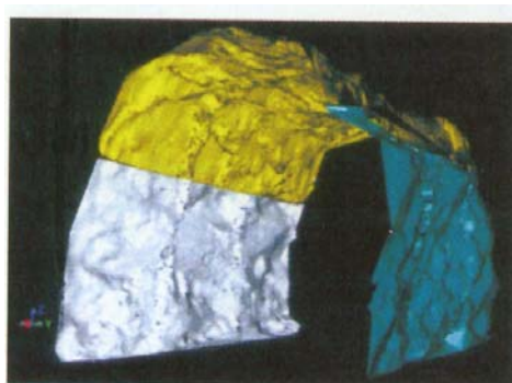
Obrázek 2.28: Využití v podzemních prostorech (tunely, jeskyně) – ukázka digitálního modelu průzkumné štoly, zdroj [9].
