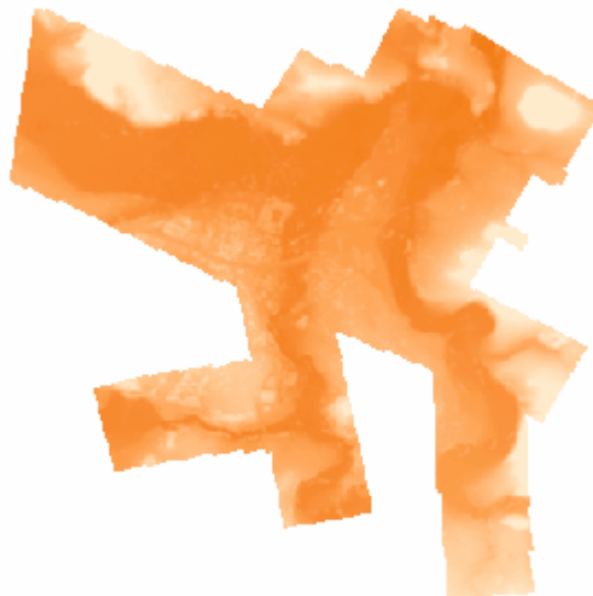
Obr 3.2.2 DMT rastr vytvořený na základě FGM měření
