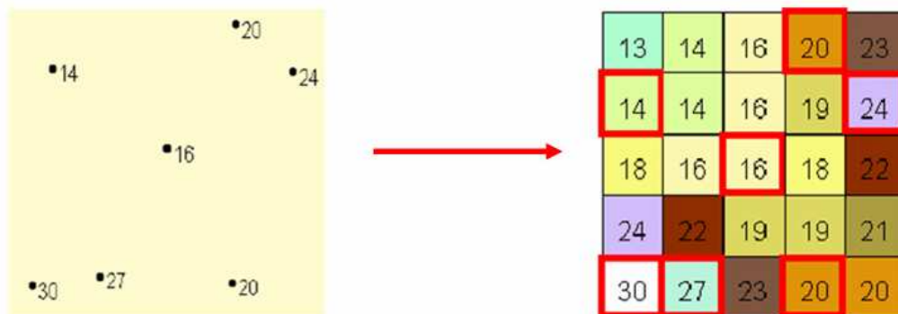
Obr. 2.13 Ukázkou principu interpolace z vektorových dat na rastr. Zpracováno podle [17]
