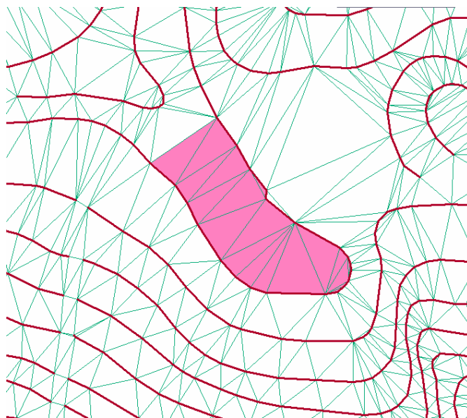
Obr. 3.2 Ukázka TIN odvozeného z vrstevnic s vyznačeným případem falešného spočinku.
