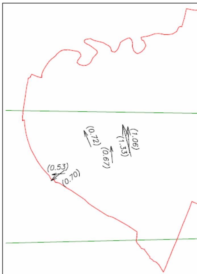
Vektory znázorňující rozdíly poloh identických bodů určených ze dvou sousedních ortofotosnímků č. 1423 a 1450
