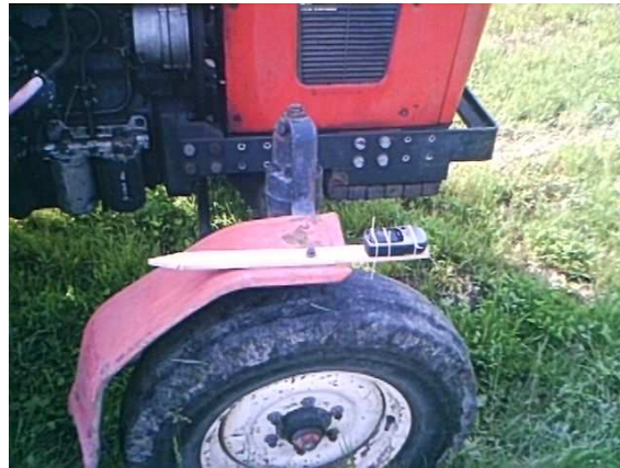
Obrázek 7: Připevnění GNSS navigace na pravé kolo traktoru
