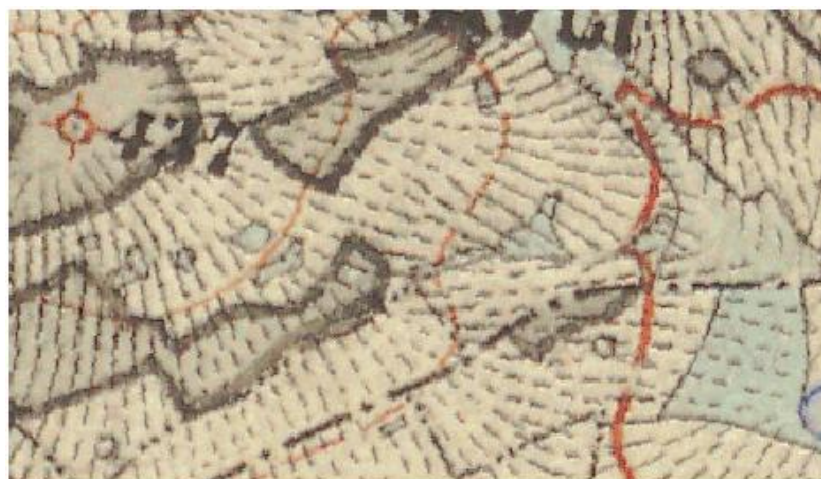
Obr. 3.7: Kóta a vrstevnice. Od leva: kóta (437m.n.m.), mezilehlá vrstevnice (420m.n.m.), doplňková vrstevnice (410m.n.m.) a hlavní vrstevnice (400m.n.m.). (zdroj: [26])
