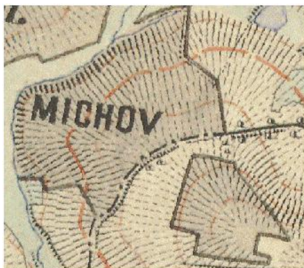
Obr. 3.4: Lesy – okraje polygonu lesa končící komunikací a vodním tokem bez zvýraznění okraje polygonu. (zdroj: [26])
