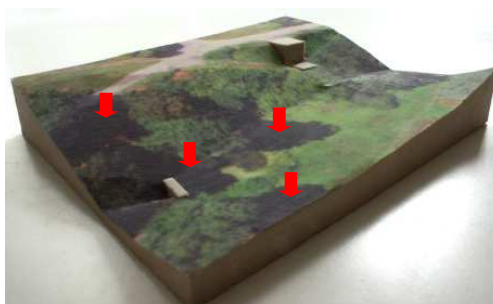
Obr. 4.5 Model reliéfu vytvořený pomocí metody 3DP, zdroj Šuba (2010)
