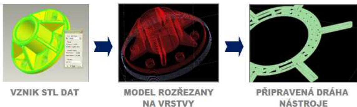
Obr. 1.3 Obecný princip přípravy virtuálního 3D modelu pro tisk metodami RP, zdroj Ferda (2007)
